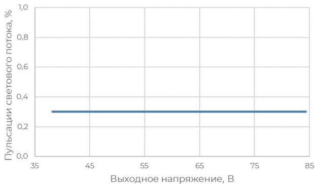
Рис. 3 - Зависимость пульсаций светового потока от выходного напряжения
